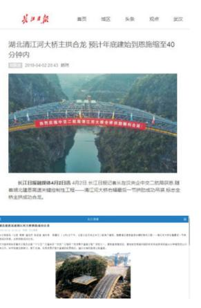
V形河谷，坡度近似直立状，相对高差102米。施工难度极大，安全环保要求高。大桥采用无支架缆索吊悬拼工艺，利用缆索吊机系统对全桥劲性骨架拱肋、拱箱、拱上结构及桥面板实施吊装施工，这就如同高空积木，各构件通过吊具起吊后，由起重跑车顺着主缆将其送到指定位置，精准对接。（施中良）
